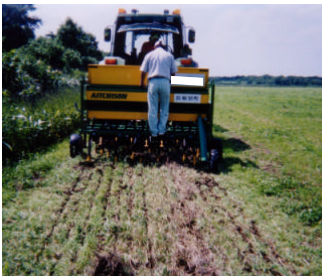
写真11 ヘレニアルライグラス追播 作溝型播種機
