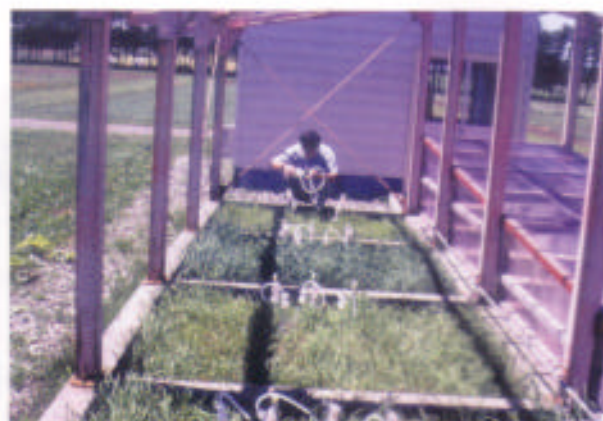
酪農周辺環境の負荷軽減対策試験 (ライシメーターによる養分動態解析)
