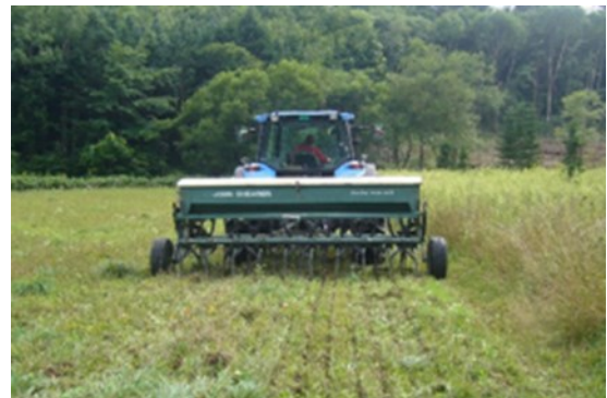
簡易更新機による作業
