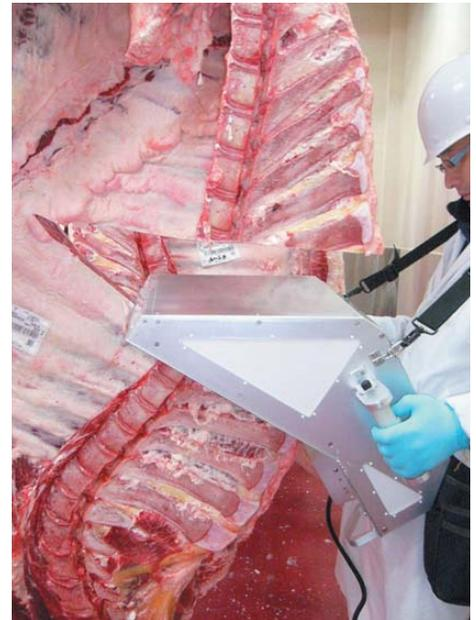
図3 ミラー型撮影装置による枝肉撮影風景
