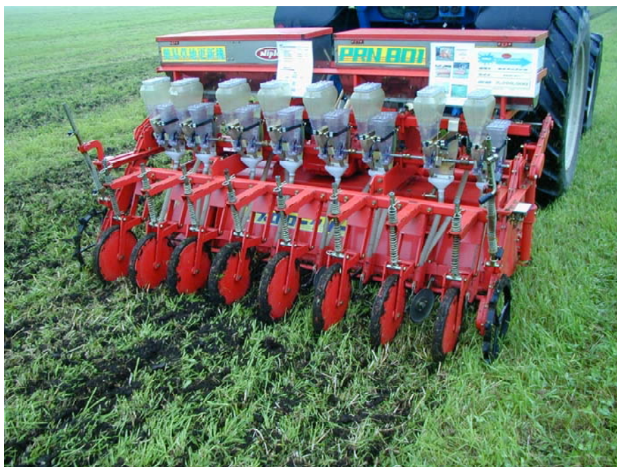
写真4 部分耕型播種機による播種作業 (溝状に部分耕耘、施肥、播種、鎮圧を一行程で行える。)
