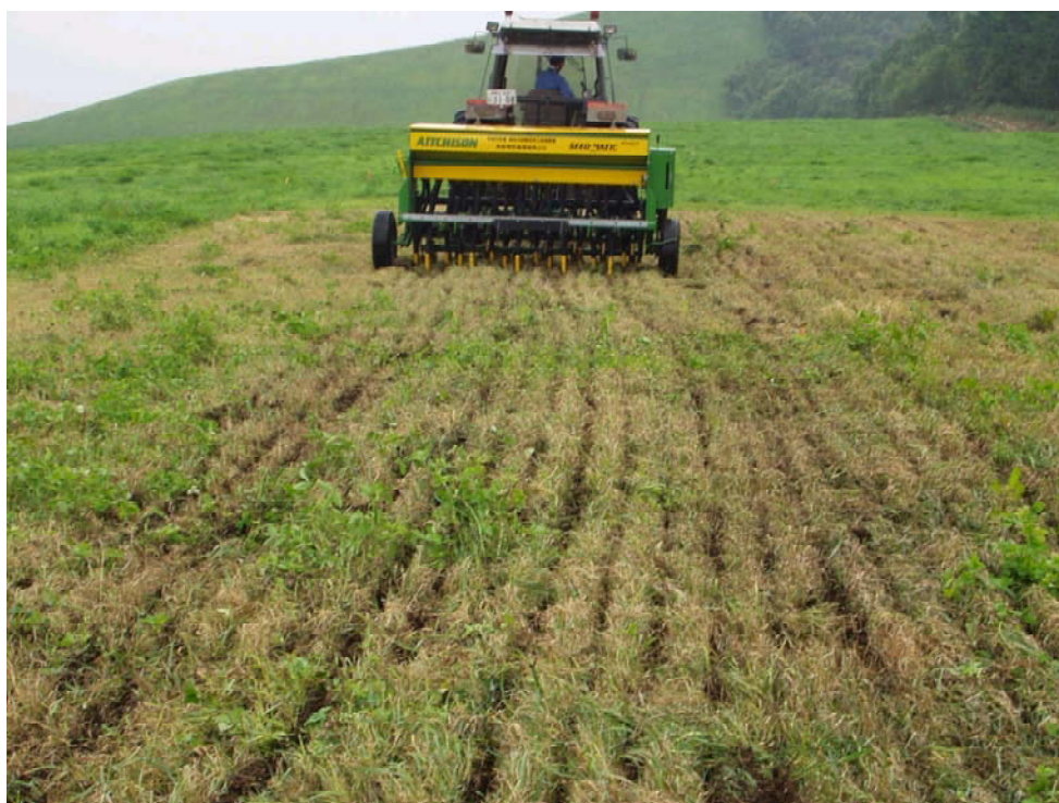
写真2 作溝型播種機（通常幅）による播種作業 （作溝、施肥、播種を同時に行えるタイプ；溝間隔は15cm）
