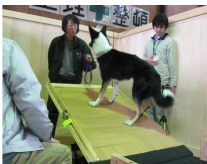
写真 犬による実証試験 (傾斜法試験)
