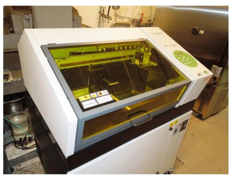
最大100mmの高さの立体素材(紙、PET素材やABS、PVC、ポリカーボネート、ポリスチレン等)にダイレクトプリントが可能です。高低差2mmまでの曲面にも印刷をすることができます。
