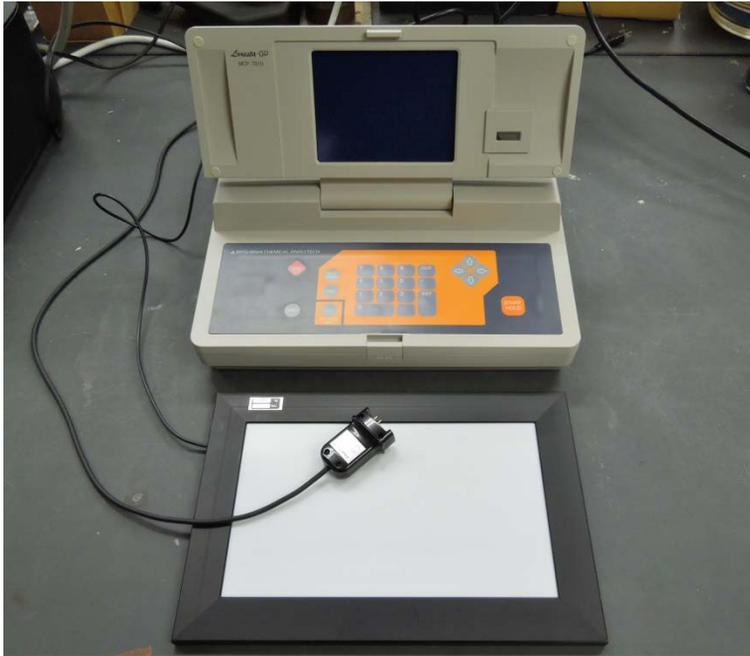
材料の表面抵抗率及び体積抵抗率を測定する装置です。電気伝導性の良好な低抵抗材料の抵抗率測定が可能です。
