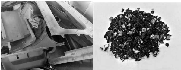
図1 自動車から回収された部品（左）と粉碎されたプラスチック（右）
