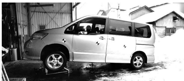
図4 時速10.2kmの衝突試験後の様子
