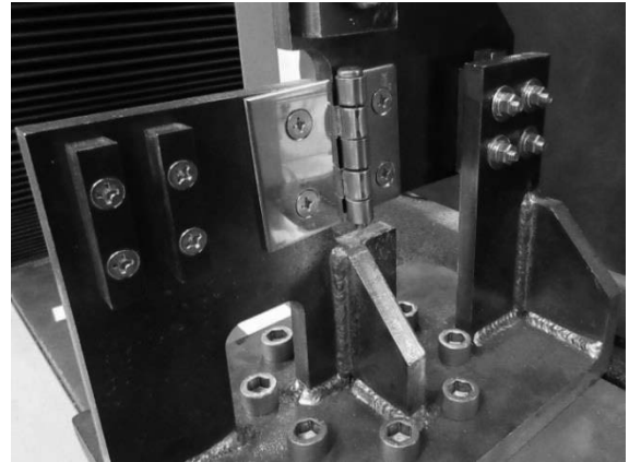
写真1 ドアヒンジの強度試験
