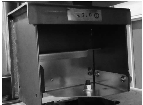
写真2 固定金具の強度試験
