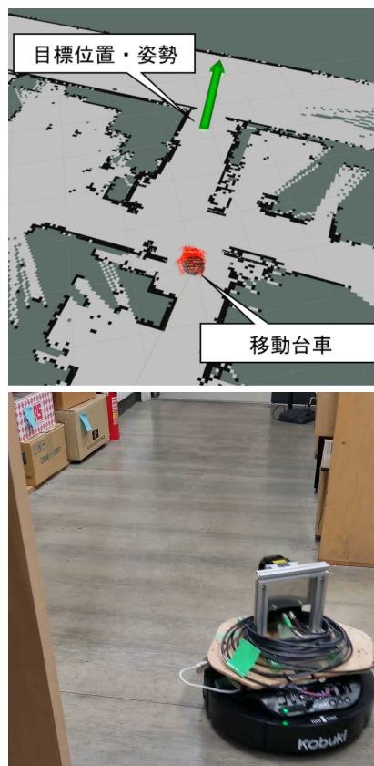
図2 作成した環境地図と目標に接近する移動台車
