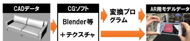
図2 CADデータからのAR用モデルデータの作成工程
