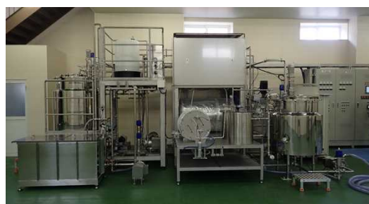
図2 コンドロイチン硫酸オリゴ糖生産システム
