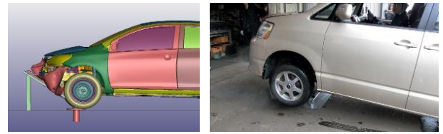
図4 誤発進対策安全車止めのシミュレーション結果と実験結果の比較
