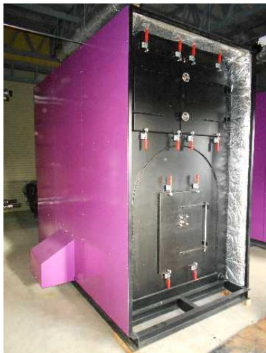
図2 開発ボイラ（高灰分対応型バイオマスボイラ）
