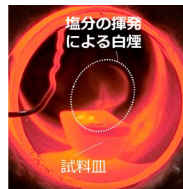
(a)炉内で発生した白煙 (b)塩が析出した炉壁 図4 目視による塩分飛散の確認（炉内温度1000℃）
