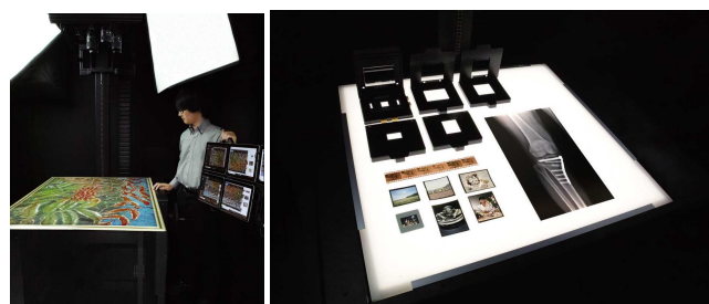
図2 透過光源を内蔵した撮影台
