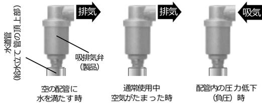
図1 吸排気弁（現行モデル）の外観と動作
