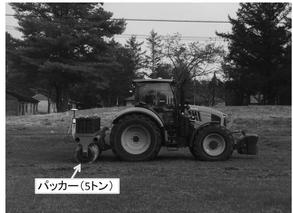
図4 自動走行試験風景（パッカー牽引）
