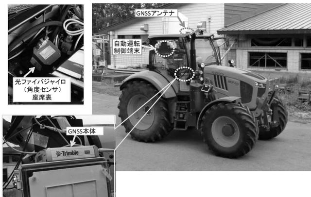
図1 自動走行用に改造したトラクタ
