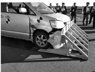
図5 重量柵衝突結果
