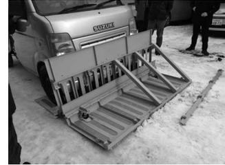
図9 積雪路面上での衝突試験
