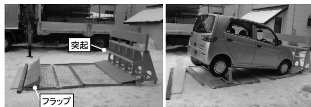
図3 試作2号機の低速衝突実験の様子 (左：試作2号機外観、右：実験結果)
