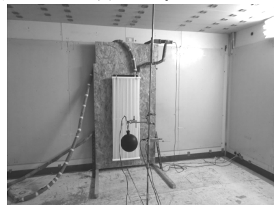
図1 放射パネルの放熱能力測定状況
