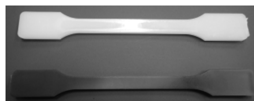
図2 ダンベル型試験片 上) PA6、下) 10%CNF強化PA6
