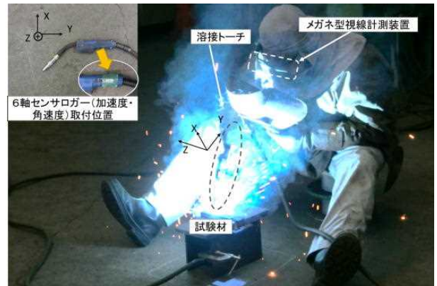
図2 溶接トーチの動き計測風景
