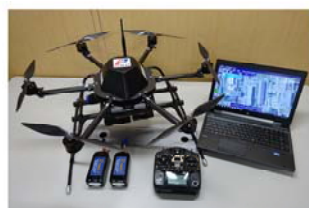
マルチローター型 UAV 一式 本体・送信機・バッテリー・地上局 PC
