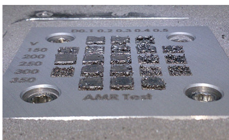
図1 脆性金属を積層造形した際の不具合の例
