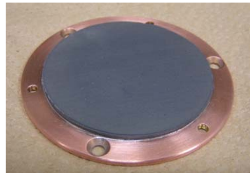
図2 試作した IGZO 用ターゲット材の外観
