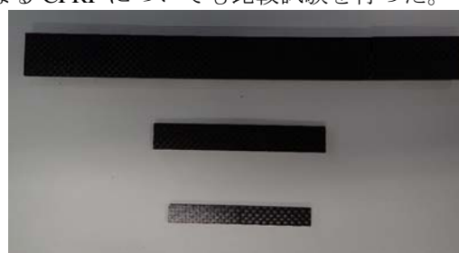
図2 CFRTP試験片(上:引張、中:三点曲げ、下:シャルピー衝撃)
