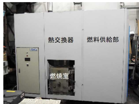
図2 廃ポリスチレン ペレット燃焼ボイラ
