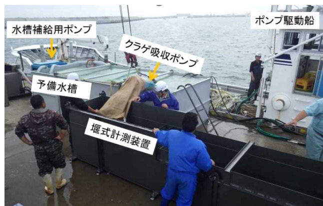
図1 クラゲポンプの流量計測試験の様子
