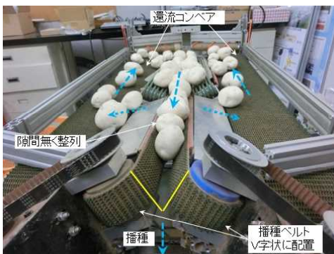
図1 高速搬送・播種機構（室内試作機）
