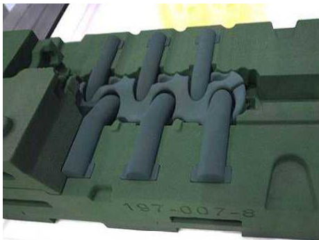
図1 開発装置で製作した鋳型例
