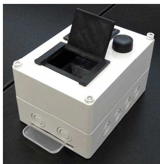
図1 試作したポータブル生乳検査装置
