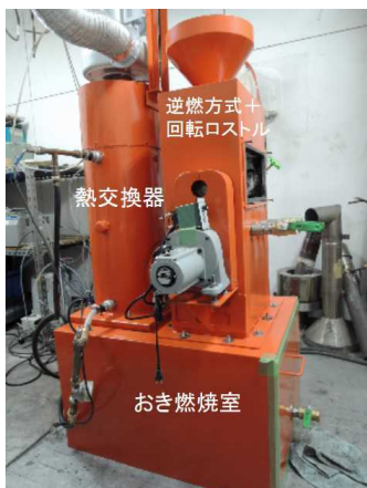
図1 モミガラ 燃焼ボイラ
