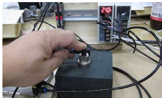
図3 通気抵抗による通気度評価実証試験の様子
