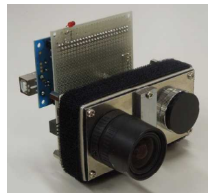
図2 試作した進入接近検知センサ
