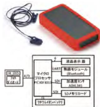
試作した処理回路
