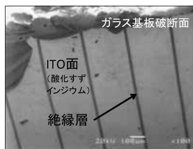
液晶パネルガラス内面のSEM写真
