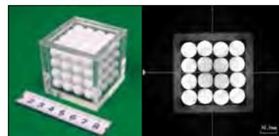
内部空隙率測定試料とX線CT像
