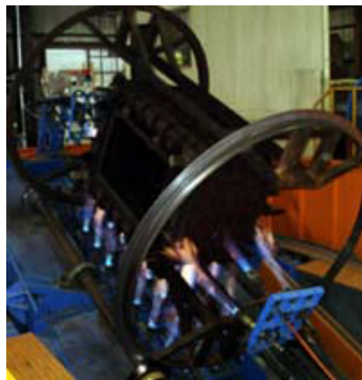
原料の投入および回転成形の状況
