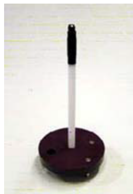
分解能測定用対比試験体 (7 \mu mフィルム積層)
