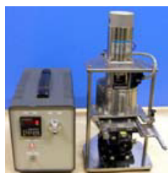
動物骨用高速粉碎処理装置と粉碎ユニット
