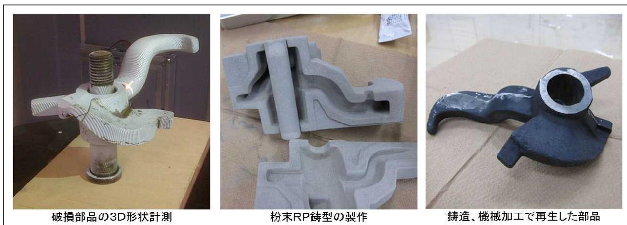
破損部品の3D形状計測
