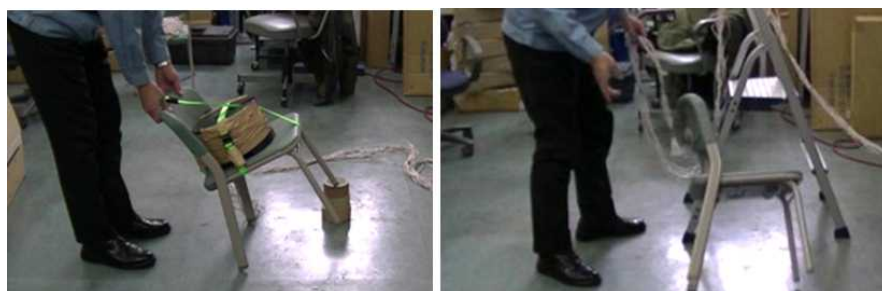
強度試験の様子（左：前脚上げ、右：落下）
