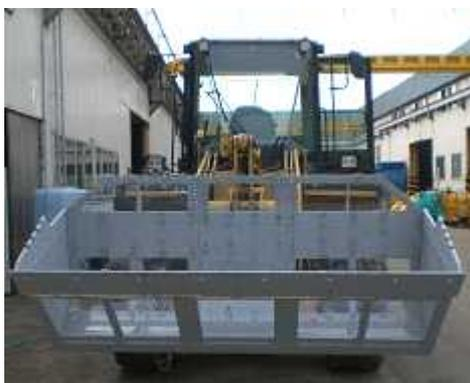
試作した除雪用バケツ
