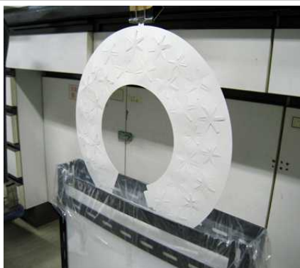
図2 ディップ法による光触媒塗布
