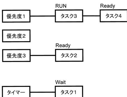
図3 実行中のタスクが待ち状態になったレディキューの接続例
