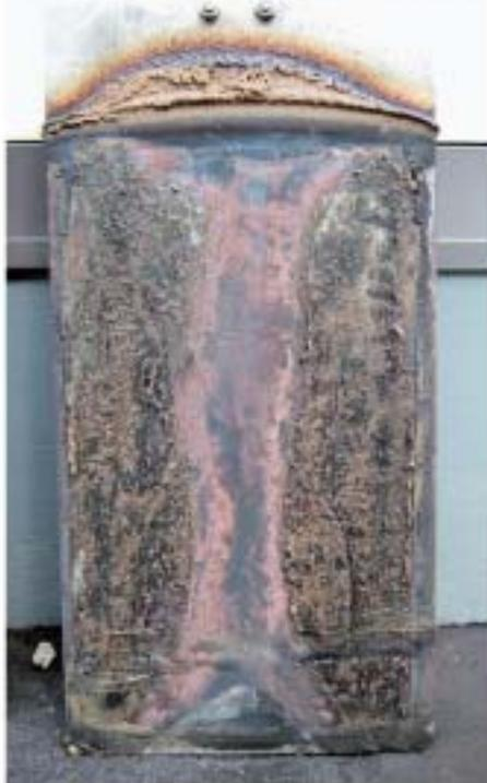
図5 固形分電解時に再溶解が発生した際の電極板
