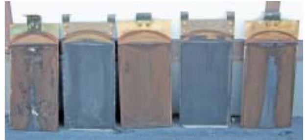
図6 再電解開始後再び電解処理を中断し取り出した電極板
