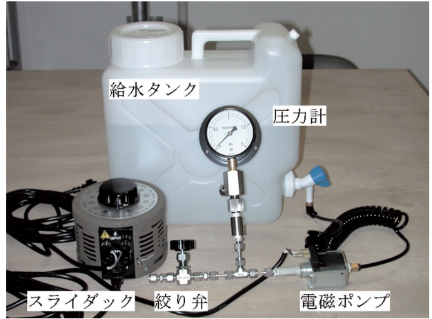
図3 給水装置の構成
