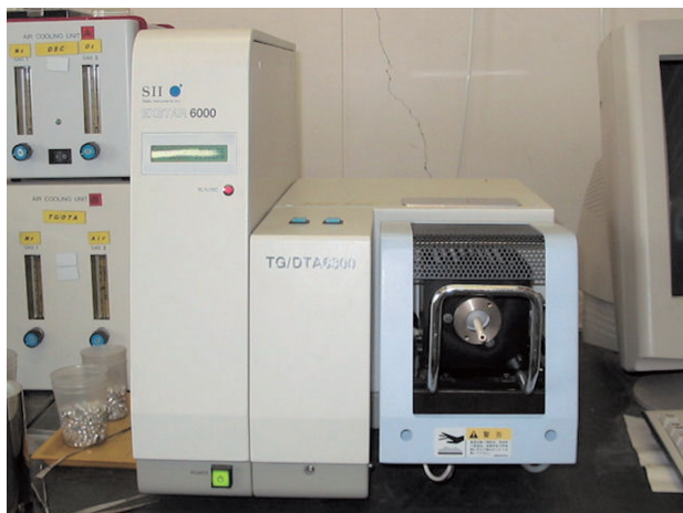
図6 熱分析装置 (SII EXSTAR TG/DTA 6300)
