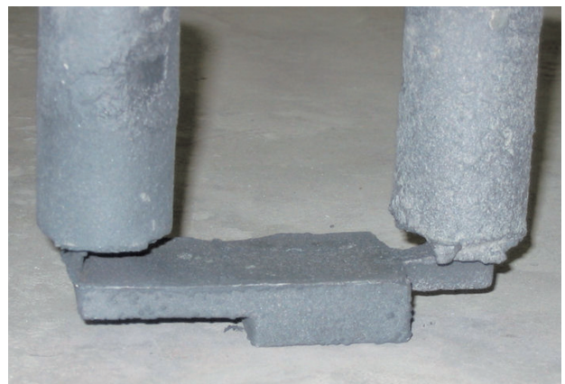
図18 試験用鋳型で鋳造した鋳鉄鋳物の外観
