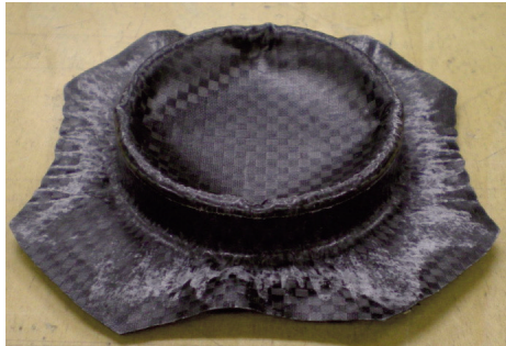
金型温度：150℃，材料予熱温度：200℃ 材料予熱時間：8分，下死点停止時間：30秒
