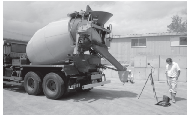
図6 トラックミキサ攪拌音の計測実験
