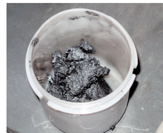
図1 薄片化黒鉛の水分散材
