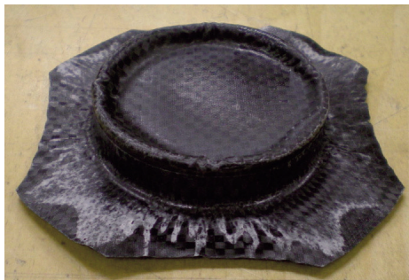
金型温度：150℃，材料予熱温度：200℃ 材料予熱時間：6分，下死点停止時間：60秒
