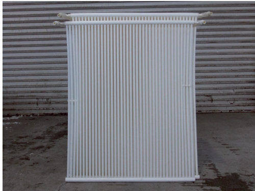
図3 プロトタイプ温泉熱回収用熱交換器の模式図と外観
