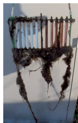
図13 テストピースに髪の毛が絡まる様子
