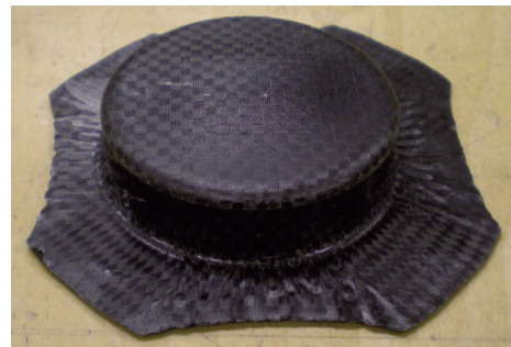
金型温度：130℃，材料予熱温度：200℃ 材料予熱時間：8分，下死点停止時間：60秒
