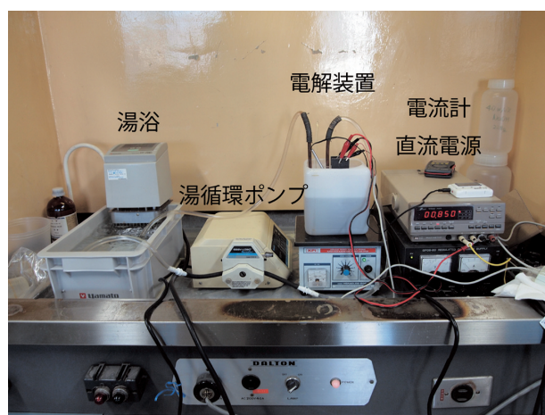
図2 電解装置(電解条件検討用)
