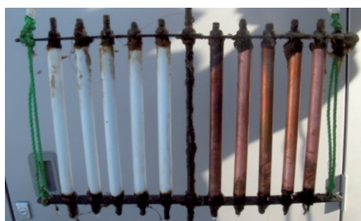
図12 排湯浸漬4ヶ月後のテストピースの外観 (左5ピース；PPR管，右5ピース；銅管)
