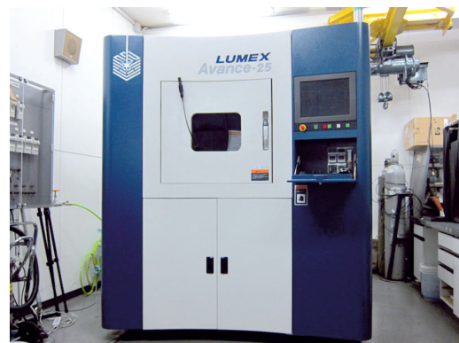
図2 金属粉末積層造形装置の外観 (松浦機械製作所 5) 製 LUMEX Avance-25)
