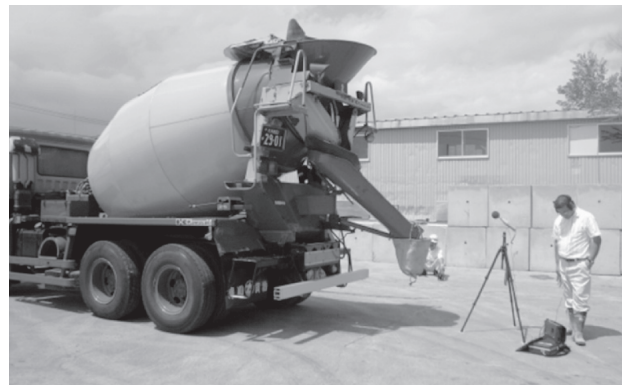
図6 トラックミキサ攪拌音の計測実験
