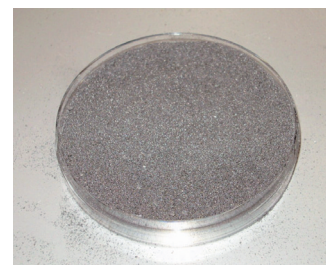
図2 薄片化黒鉛をコーティングしたプラスチック粉体
