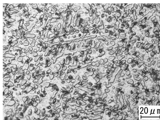
図11 Sn-50%(Zn-5%Al)の断面組織
