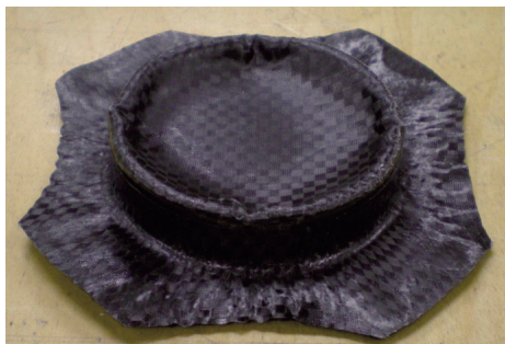
型温度：150℃，材料予熱温度：200℃ 材料予熱時間：6分，下死点停止時間：30秒
