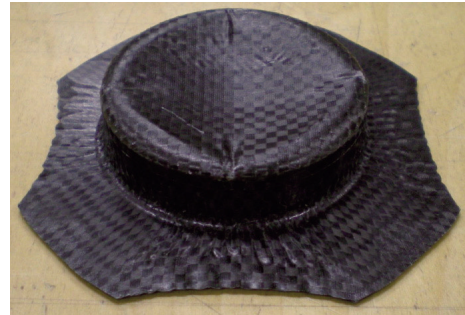
金型温度：130℃，材料予熱温度：200℃ 材料予熱時間：8分，下死点停止時間：30秒
