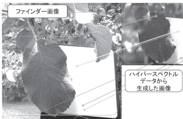
図11 ハイパースペクトルデータから生成した画像とファインダ画像の特徴量
