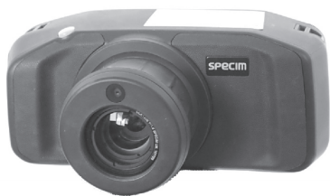
図1 ハイパースペクトルカメラ Specim IQ
