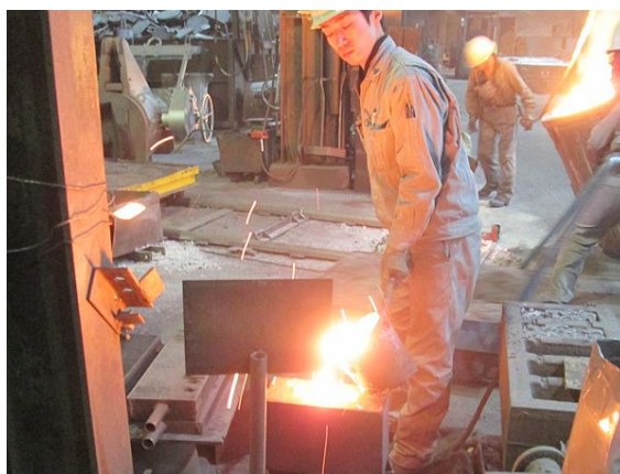
鋳型温度計測のための鋳造実験の様子
