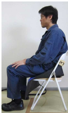
座面圧力分布計測（左：ウレタン座面 右：漁網座面）
