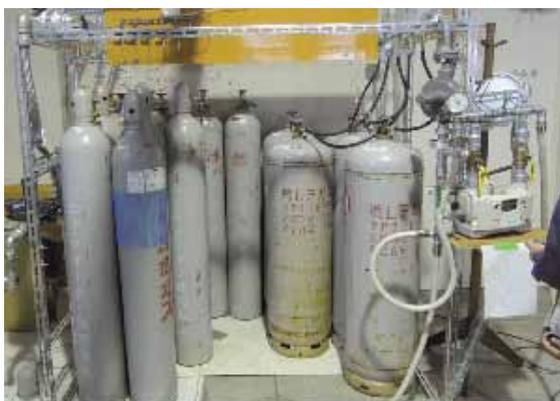
模擬ガス製造装置
