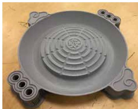
図3. 大型3Dプリンターで試作したジンギスカン鍋
