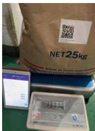
図1 無線重量計とQRコードによる材料の計量
