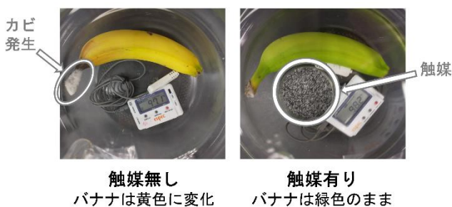
図3 プラチナ触媒による未熟果バナナの貯蔵試験
