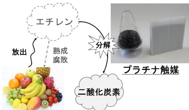
図1 プラチナ触媒による青果物の鮮度保持技術
