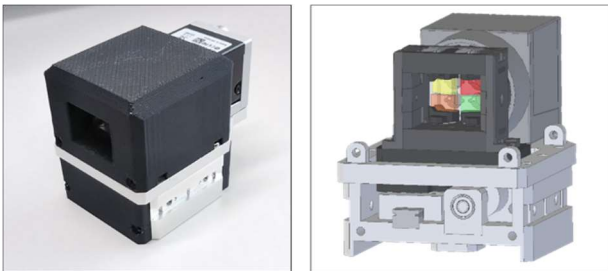
図6 CMOS カメラと複数の光学フィルタで構成した多眼式分光イメージングセンサ (左：外観、右：内部構造)
