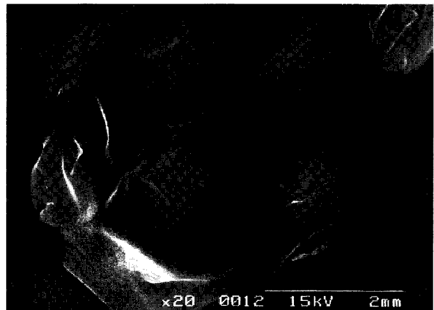
図3 膨化品断面図 (PVA 添加原料)
