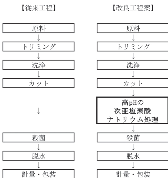
図5 高pHの次亜塩素酸ナトリウムを用いた付着細菌除去技術のカット野菜製造工程への応用
