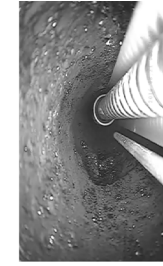
UCC模型実験における石炭のレーザー着火
