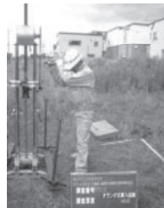
図-16 オランダ式二重管コーン貫入試験機
