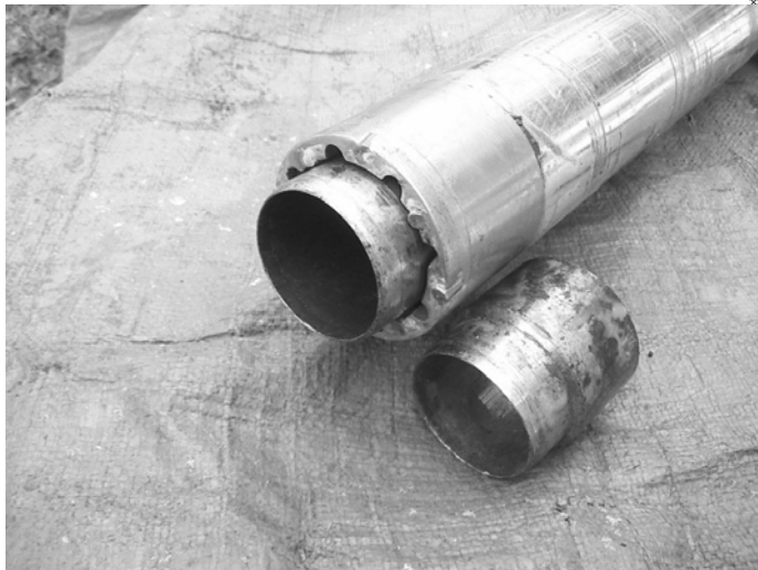
メタルビットとシュー（バスケット） シューはビットより突出している
