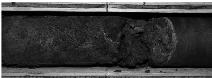
すべり面の位置—崩積土と岩盤の境界—
