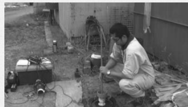
④ 送水用パイプおよび水位計を引き抜きカメラを挿入
