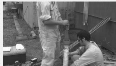
② ビニールチューブを送水用パイプで孔底まで挿入する
