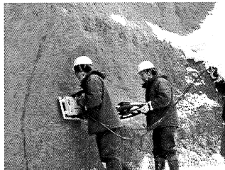
プロフィール測定風景 (450MHz)
