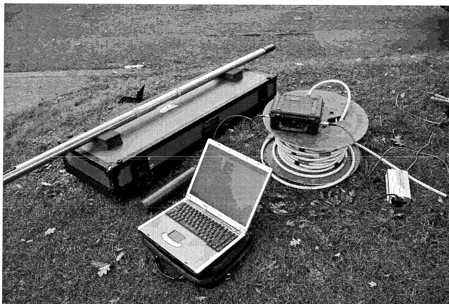
写真-1 C-ALS システムの構成
