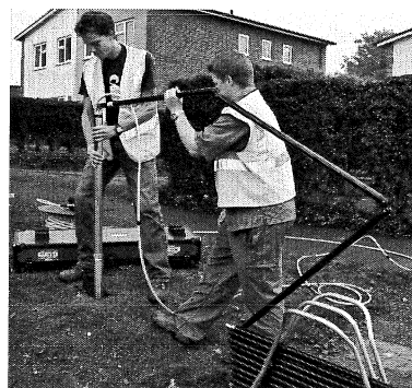
写真-4 挿入ロッド(Boretrak)
