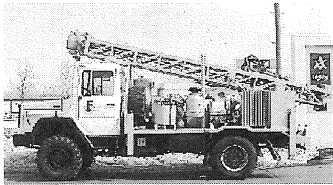
トラック搭載型トップドライブ工法（写真）
