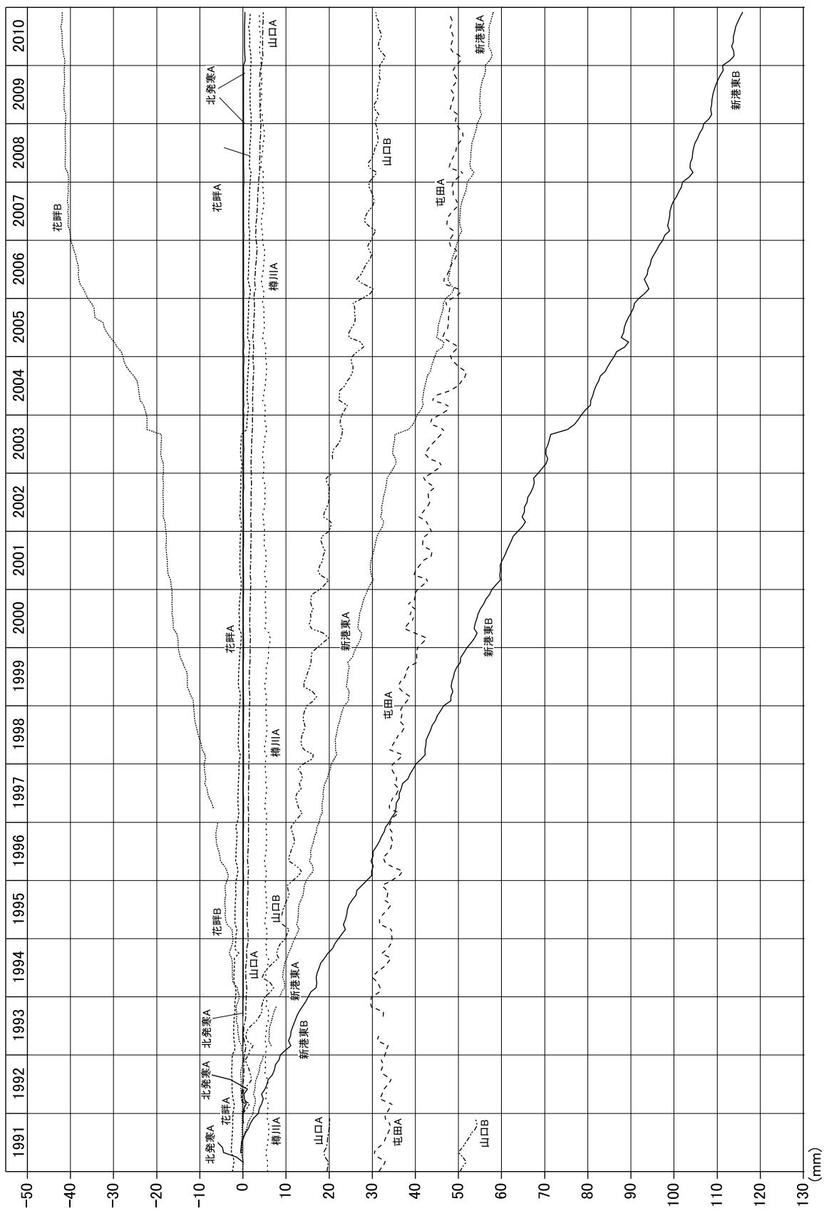
観測井地盤沈下経年変化図(3)
