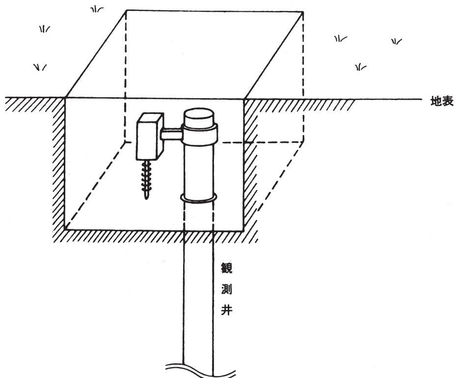
図 北発塞 A 沈下観測方式概念図
